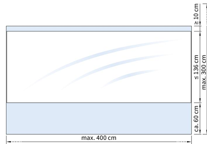
Grundmaterial der markilux Panoramafenster ist eine transparente UV-beständige Folie. Das Ein- und Ausfahren ist nur im Temperaturbereich zwischen + 5° und +35° zulässig. Materialbedingt ist eine Einrübung der Fensterfolie möglich.
